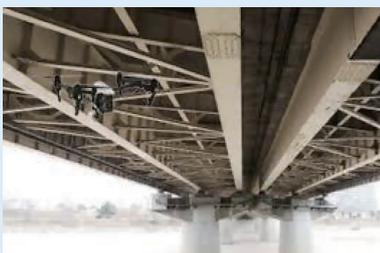
リフト車のゴンドラに乗って人が目視で行っていた作業は、手間がかかり多くの危険を伴っていた。一般的な点検と異なり、橋梁は下側から撮影をする必要があるため、機体上部にローター(プロペラ)を備える市販のドローンでの作業は接触などの際に墜落するリスクが高く敬遠されがちであった。しかし、機体上部にカメラと照明装置を付けて安全な点検作業が可能になった。
